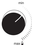
Уменьшая производительность водонагревателя и регулируя ее в соответствии с уровнем, который Вам необходим фактически, Вы сможете снизить температуру воды на выходе и сэкономить энергию. Для снижения температуры поверните регулятор мощности против часовой стрелки. Это — экономичная установка (для летнего времени).
