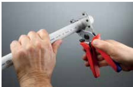
Отрезание трубы при помощи труборезных ножниц
