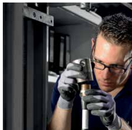
Подготовка для испытания на растяжение
