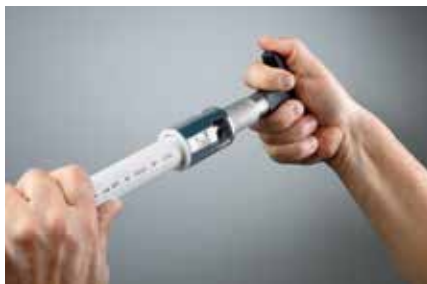
Калибровка и снятие фаски
