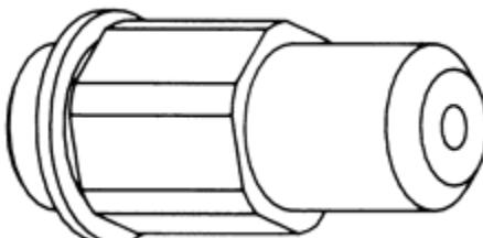
Рис. 30: Форсунка горелки
