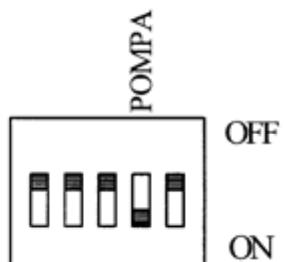
Постциркуляция насоса – 4 часа (при выключении по сигналу комнатного термостата)\*
