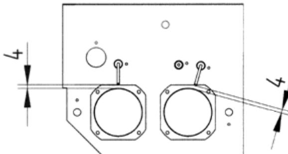
Рис. 32 Расположение электродов зажигания
