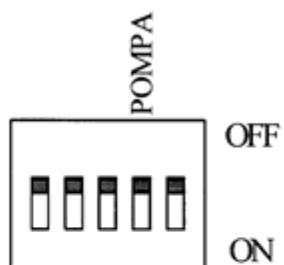
Постциркуляция насоса – 3 мин (при выключении по сигналу комнатного термостата)\*
