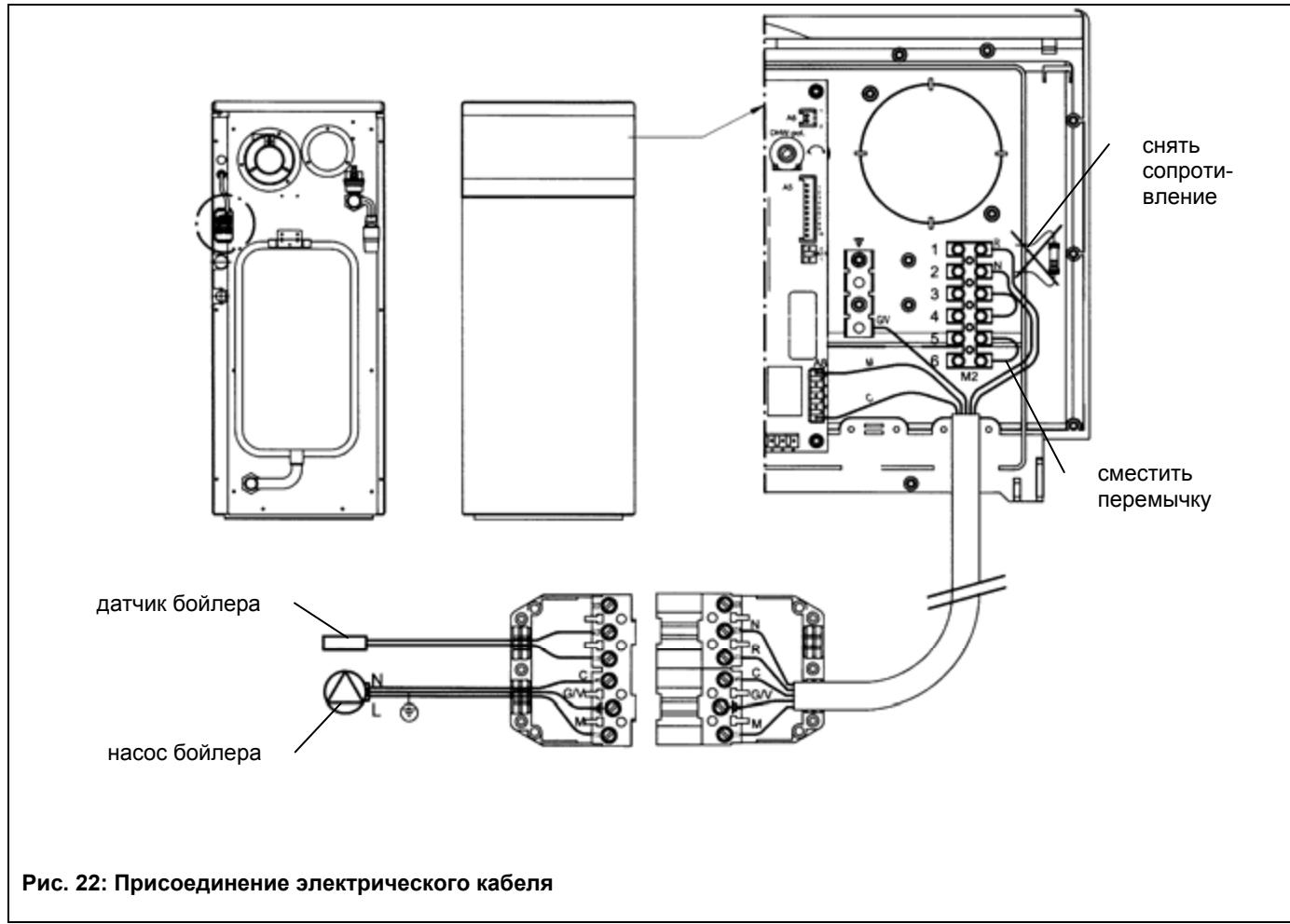
Рис. 22: Присоединение электрического кабеля
