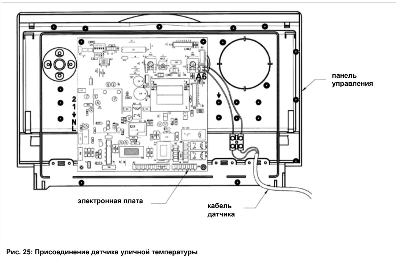
Рис. 25: Присоединение датчика уличной температуры
