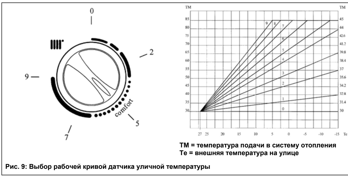
**Рис. 9: Выбор рабочей кривой датчика уличной температуры**
