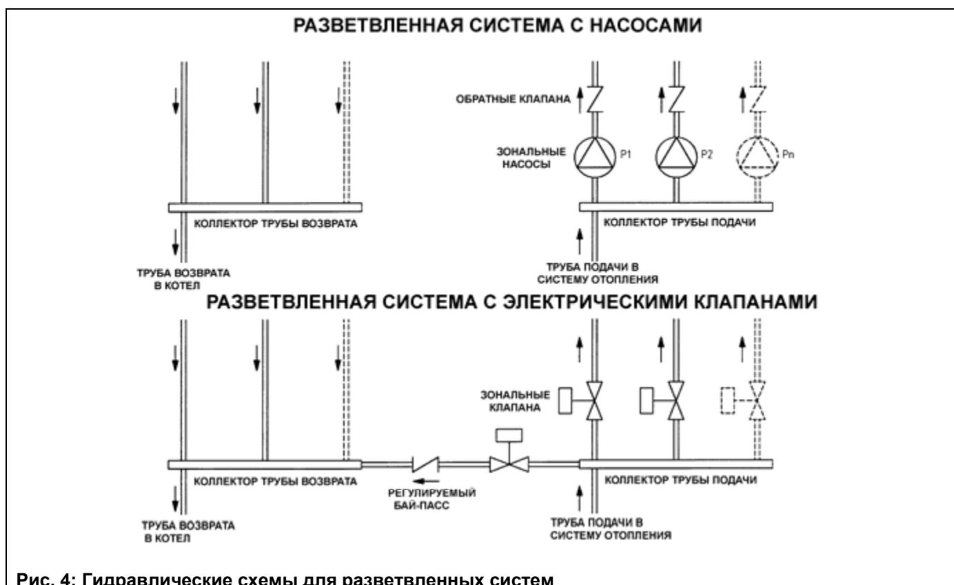
Рис. 4: Гидравлические схемы для разветвленных систем
