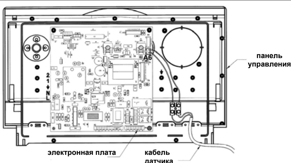
Рис. 8: Присоединение датчика уличной температуры
