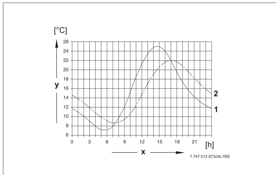
Рис. 15 Сравнение текущей и демпфиированной температуры наружного воздуха
