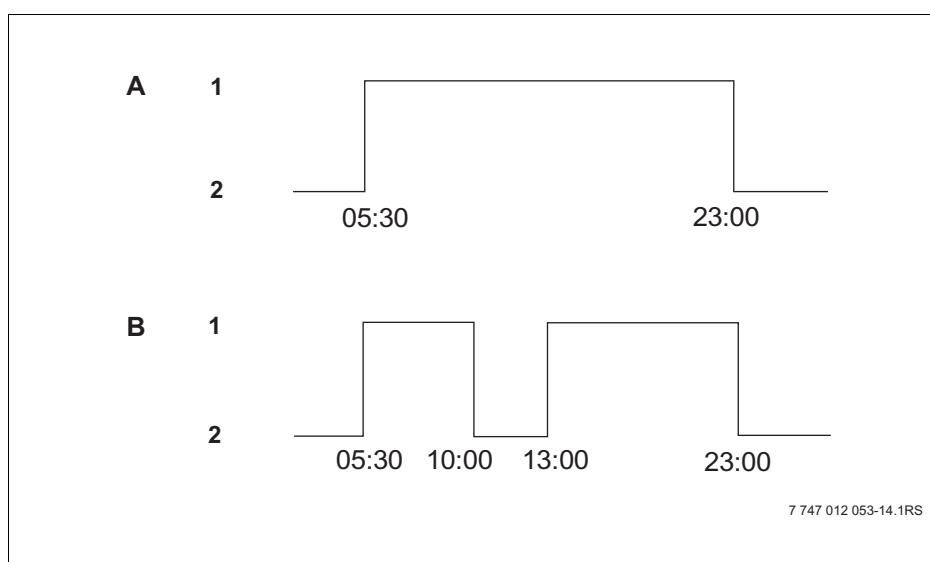
Рис. 16 Ввод точек переключения для прерывания периода отопления
