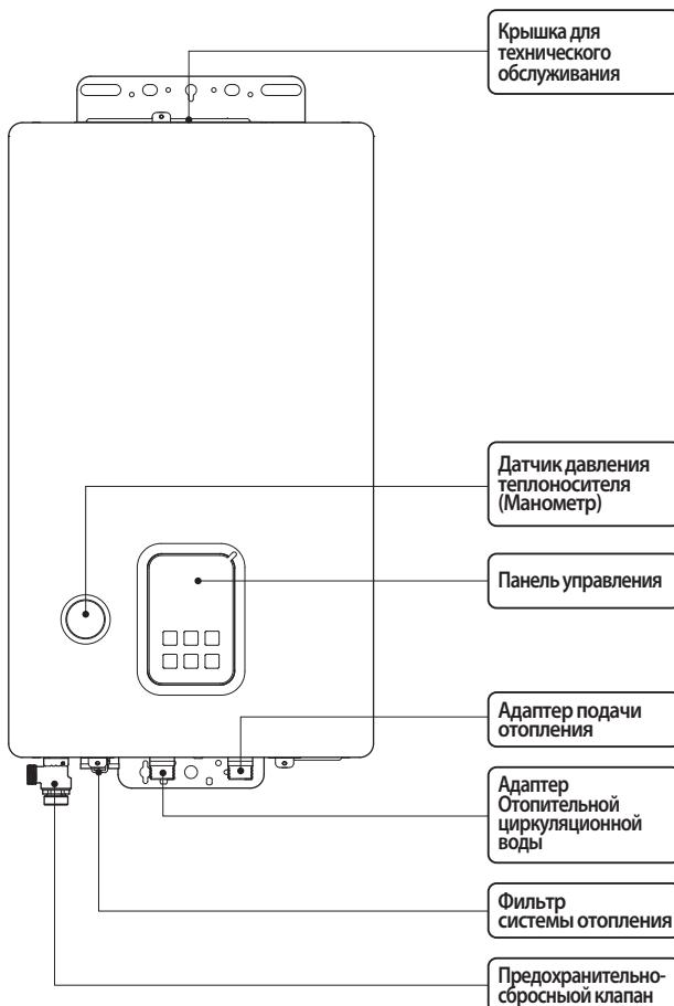
Фильтр системы отопления: улавливает вещества, засоряющие трубы.
