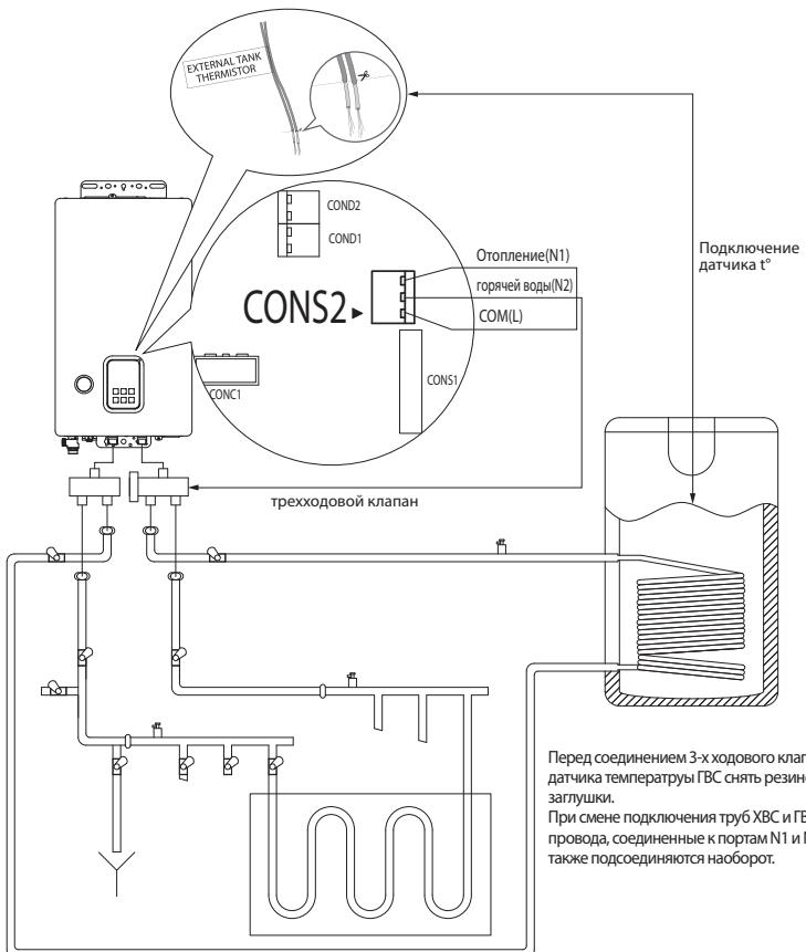
! При соединении проводов отключите электропитание, в ином случае может привести к поражению электрическим током.
