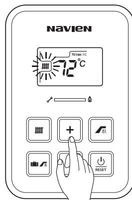
Во время мигания кнопки «Отопление» установите желаемую температуру в диапазоне 40 – 80°С. Значение температуры сохранится автоматически. Значения температуры отопления изменяются на 1°С. Котел автоматически подстраивается под желаемую температуру и с началом работы режима «Отопление» загорается индикатор «Работа». Если вы хотите отключить режим «Отопление» (полностью остановить работу котла), установите режим «Вне дома».
