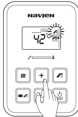
Установка значений температуры возможна в диапазоне от 30°C до 60°C. Данные сохраняются автоматически. Установка значений температуры происходит с шагом в 1°C.
