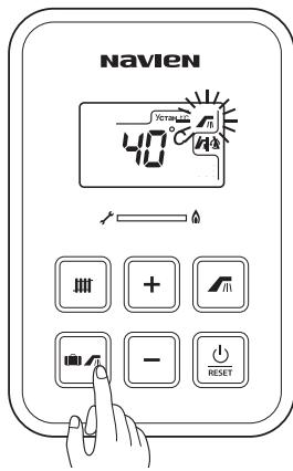
Индикатор «Отопление» сменится на индикатор «ГВС», и функция отопления работать не будет.
