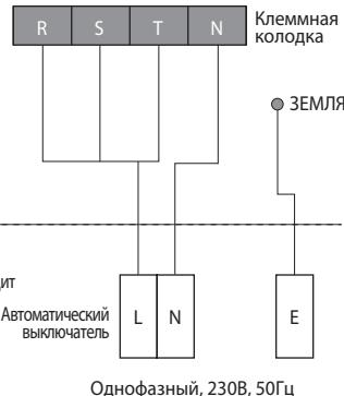
© Толщина провода заземления должна быть не менее 6SQ
