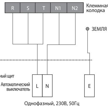
© Толщина провода заземления должна быть не менее 6SQ
