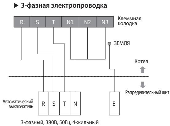
◎ Толщина провода заземления должна быть не менее 6SQ
