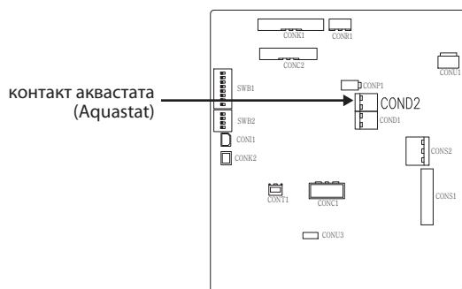
Теперь следует в зависимости от используемого датчика температуры во внешнем резервуаре для ГВС изменить установки DIP-переключателя.
