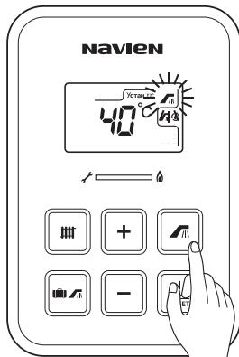
При нажатии на кнопку на дисплее мигают значения температуры горячей воды.
