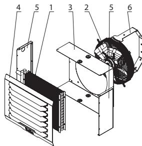
1 – Теплообменник; 2 – Осевой вентилятор; 3 – Задняя панель; 4 – Выходная решетка; 5 – боковые стенки; 6 – Кронштейн
