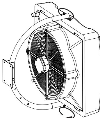
Примерное размещение тепловентиляторов при настенном монтаже
