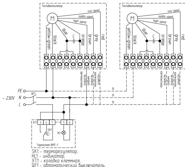
**Подключение водяного тепловентилятора
