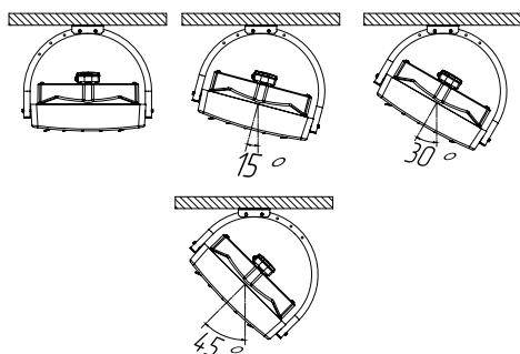
Кронштейн даёт возможность поворота тепловентилятора вокруг оси крепления на 140 градусов.
