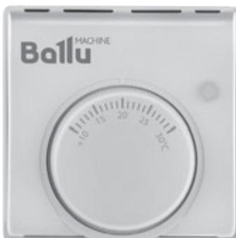
Терmostат механический BMT-1 применяется для регулирования поддерживаемой в помещении температуры. В качестве чувствительного элемента используется сильфон, заполненный газом. Обычно применяется в коммерческих помещениях, в домашних системах отопления и кондиционирования воздуха совместно с климатической техникой. Данный терmostат не устанавливается в помещениях с повышенной влажностью и в агрессивных средах (Класс защиты IP40).
