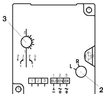
Привод имеет заводскую настройку на вращение по часовой стрелке "R". Для изменения направления вращения поверните ручку настройки (2) на "L".
