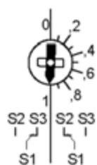
Нажмите кнопку разблокировки и поверните привод в требуемое рабочее положение, например 20% от угла вращения. Поверните ручку настройки на 1 и немного продвиньте стрелку. В результате будут настроены 20% от угла вращения (рабочее положение S1-S3).
