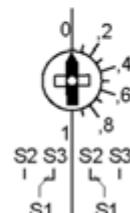
Нажмите кнопку разблокировки и поверните привод в требуемое рабочее положение, например 20% от угла вращения. Поверните ручку настройки на **0** и немного продвиньте стрелку. В результате будут настроены 20% от угла вращения (рабочее положение S1-S3).
