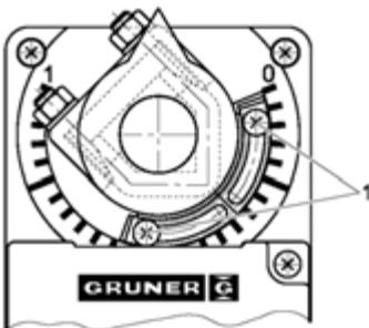
Концевые ограничители настроены на  $0^\circ$  и  $90^\circ$ . Для настройки меньших углов вращения ослабьте винты на металлических концевых ограничителях, установите концевые ограничители на требуемые значения и снова закрепите винты. Минимальный момент затягивания 1 Нм.
