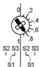
Поворачивайте ручку настройки с 1 в левую сторону до тех пор, пока стрелка не укажет на требуемое положение переключения, например 8 (20% от угла вращения). Привод поворачивается в левую сторону, и переключатель срабатывает при 20% от угла вращения (рабочее положение S1-S3).
