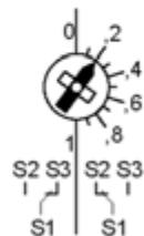
Поворачивайте ручку настройки с **0** в правую сторону до тех пор, пока стрелка не укажет на требуемое положение переключения, например 2 (20% от угла вращения). Привод поворачивается в правую сторону, и переключатель срабатывает при 20% от угла вращения (рабочее положение S1-S3).
