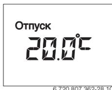
Если пульт RC200 установлен как единственный регулятор, то приготовление горячей воды и поддержание её в нагретом состоянии активны во время действия программы «Отпуск». Приготовление горячей воды от солнечного коллектора продолжает работать. Если RC200 применяется как дистанционное управление, то состояние приготовления горячей воды определяет RC300.
