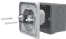
Рисунок 8. Установка терморегулятора в монтажную коробку
