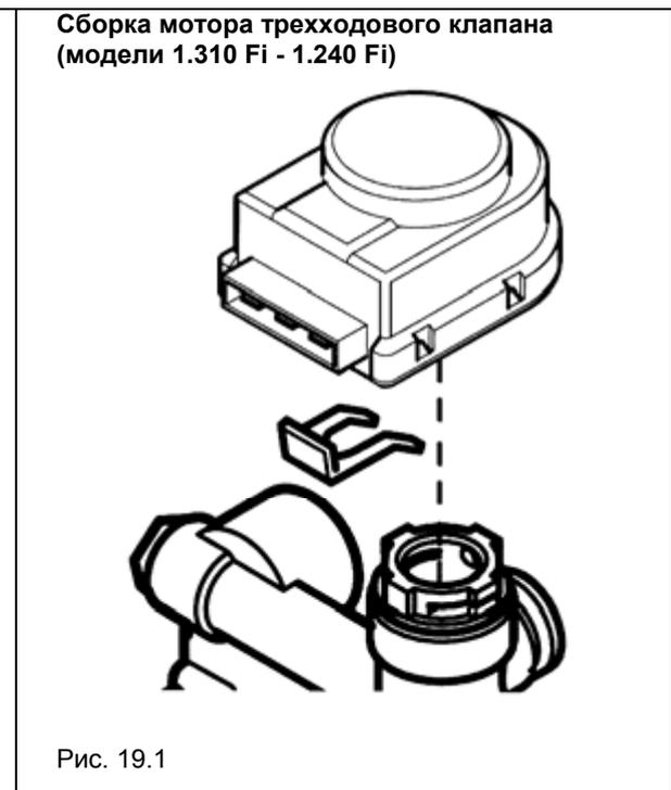
**Примечание:** удалите заглушку на трехходовом клапане перед подключением мотора.
