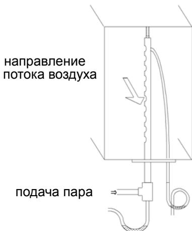
Предпочтительным является горизонтальный монтаж парораспределителей, но возможен и монтаж в климатический канал снизу.
