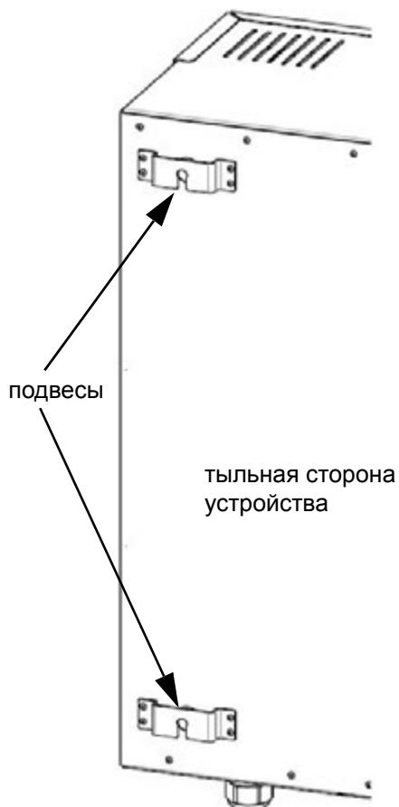
Монтаж устройства должен выполняться на прочной стене.
