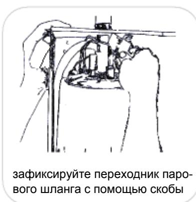
закрепите переходник парового шланга с помощью скобы
