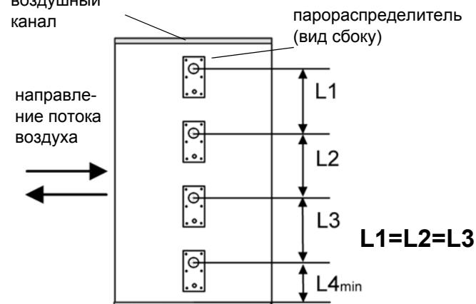
Расположение парораспределителей на равном расстоянии по высоте канала обеспечивает равномерное распределение пара в канале. По возможности используйте всю высоту канала!
