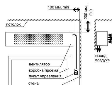
Схема задней пластины завес для горизонтальной или вертикальной установки
