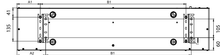
**Расположение кронштейнов для установки занавеси на шпильки**
