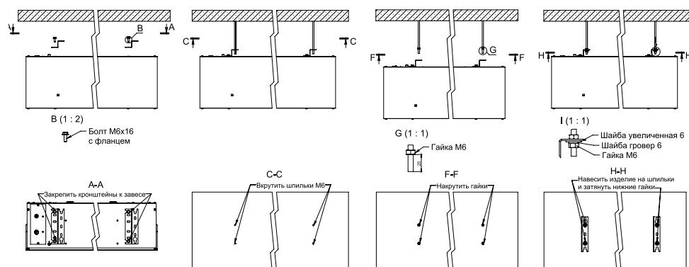
**Схема крепления завесы вертикально к стене с помощью кронштейнов**
