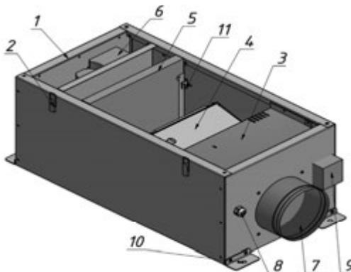
Поступающий наружный холодный воздух проходящий через воздушный клапан, фильтруется пылевым фильтром. Очищенный воздух всасывается через вентилятор, проходит через блок нагрева где подогревается до нужной температуры. Температура устанавливается на настенном пульте дистанционного управления поставляемымся в комплекте.
