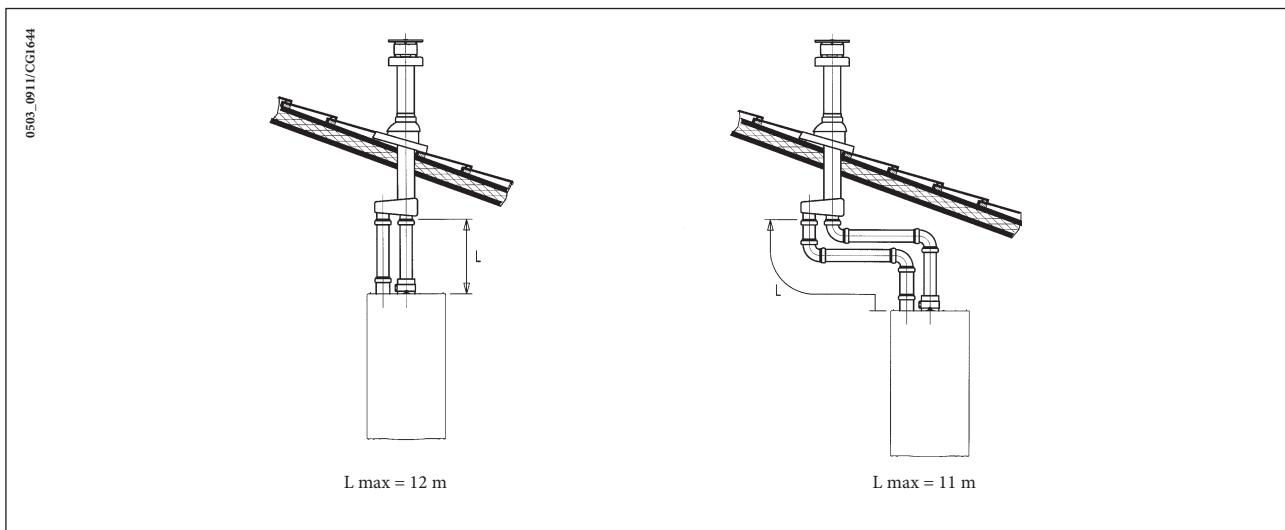
**Обратите внимание!** При установке дымохода убедитесь, что труба хорошо изолирована (напр., стекловолокном) в месте прохода трубы сквозь стену здания, согласно действующим законам, правилам и нормативам. Подробные инструкции об установке труб смотри в руководствах, прилагаемых к комплектам.
