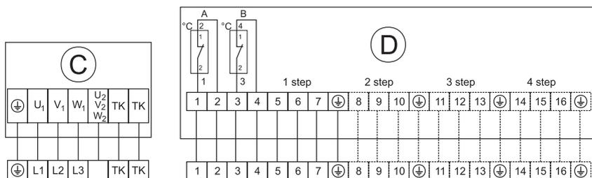
Число ступеней (step) на конкретной клеммной колодке определяется числом ступеней мощности электронагревателя установки.
