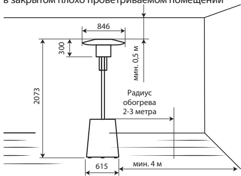
Рис. 1в – Размеры прибора и допуски (0,5 min)
