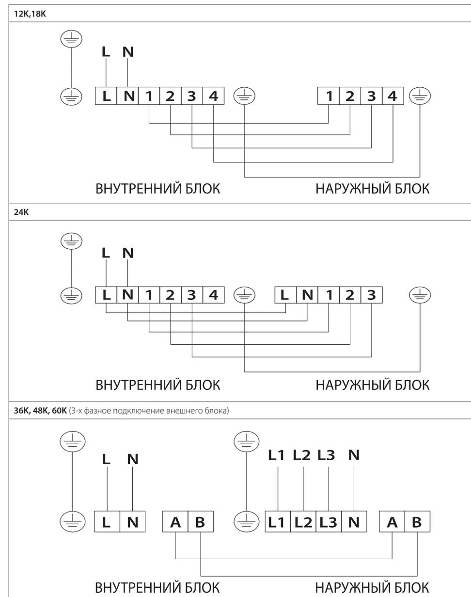
4.2. СХЕМЫ ЭЛЕКТРИЧЕСКИХ СОЕДИНЕНИЙ ВНУТРЕННИХ БЛОКОВ:
