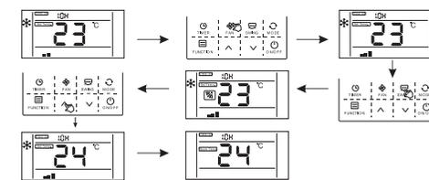
Временной интервал: 0,5 ~ 24 часа. нажмите кнопку «^» или «v» один раз, время увеличится или уменьшится на 0,5 часа. Если время отсчета превышает 10 часов, при нажатии кнопки «^» или «v» один раз, время отсчета увеличится или уменьшится на 1 час.
