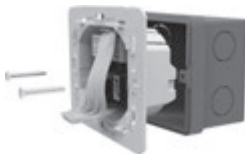
Рисунок 6. Установка терморегулятора в монтажную коробку
