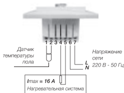
Рисунок 4. Схема подключения к терморегулятору
